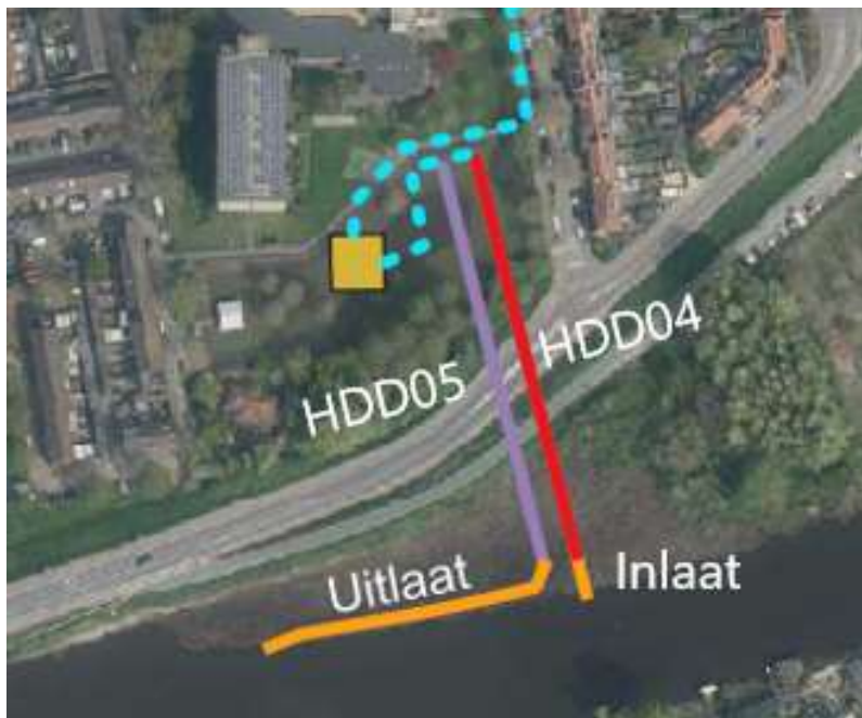
Afbeelding 3.2 - Tracé van boringen HDD04 en HDD05, de locatie van open ontgravingen voor inpassing van TEO en WKO leidingen en de locatie van in- en uitlaat van de TEO installatie.
