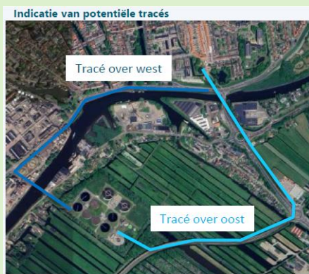
Mogelijke routes van de AWZI naar de kop van de Krugerlaan, waar het warme afvalwater 'opgewerkt' kan worden naar bijvoorbeeld 70°C.
