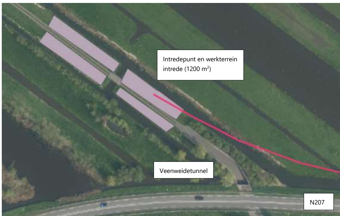
Afbeelding 4.7 Benodigde werkruimte intredepunt boring HDD01 (1.200 m 2 )
