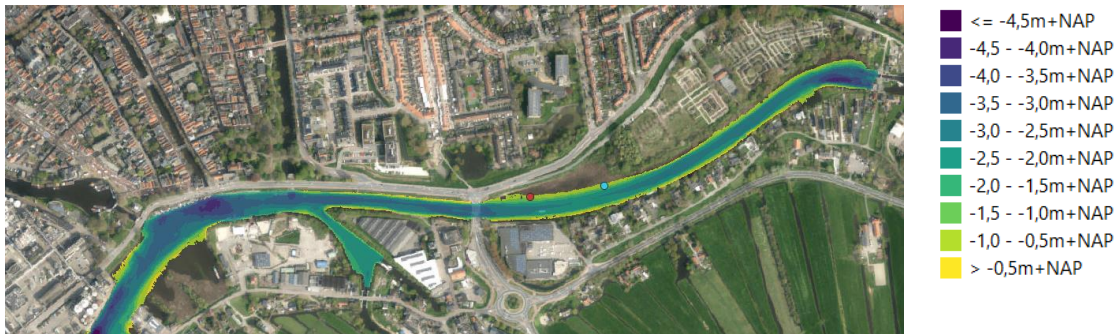
Afbeelding 2.1 Bodemhoogte van de Hollandse IJssel nabij de TEO [ref. Rijkswaterstaat (2024)], locatie lozing (blauwe cirkel) en onttrekking (rode cirkel)
