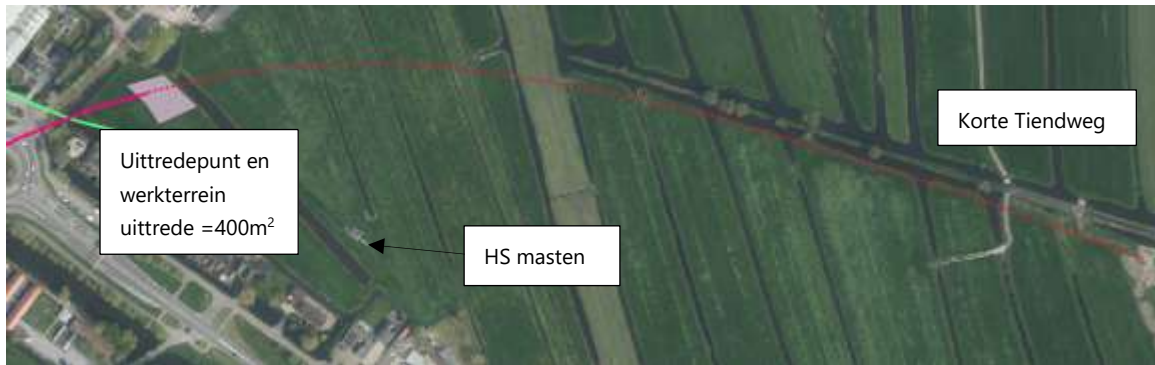
Afbeelding 4.8 Uitlegstrook boring HDD01 (rode stippellijn) en werkterrein uittrede (400 m 2 )
