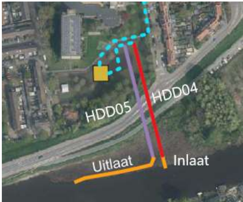
Afbeelding 6.2 Tracé open ontgraving op Zelling Vuilebras (oranje lijnen)
