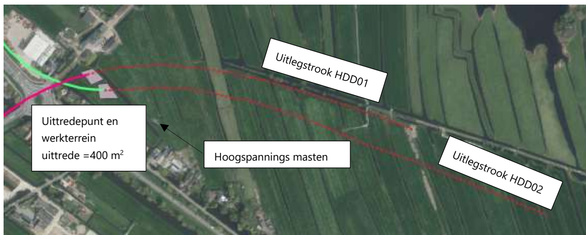
Afbeelding 4.15 Uittredepunt HDD02 met uitlegstrook. boring HDD02 (rode stippellijn) en werkterrein uittrede (400 m 2 )
