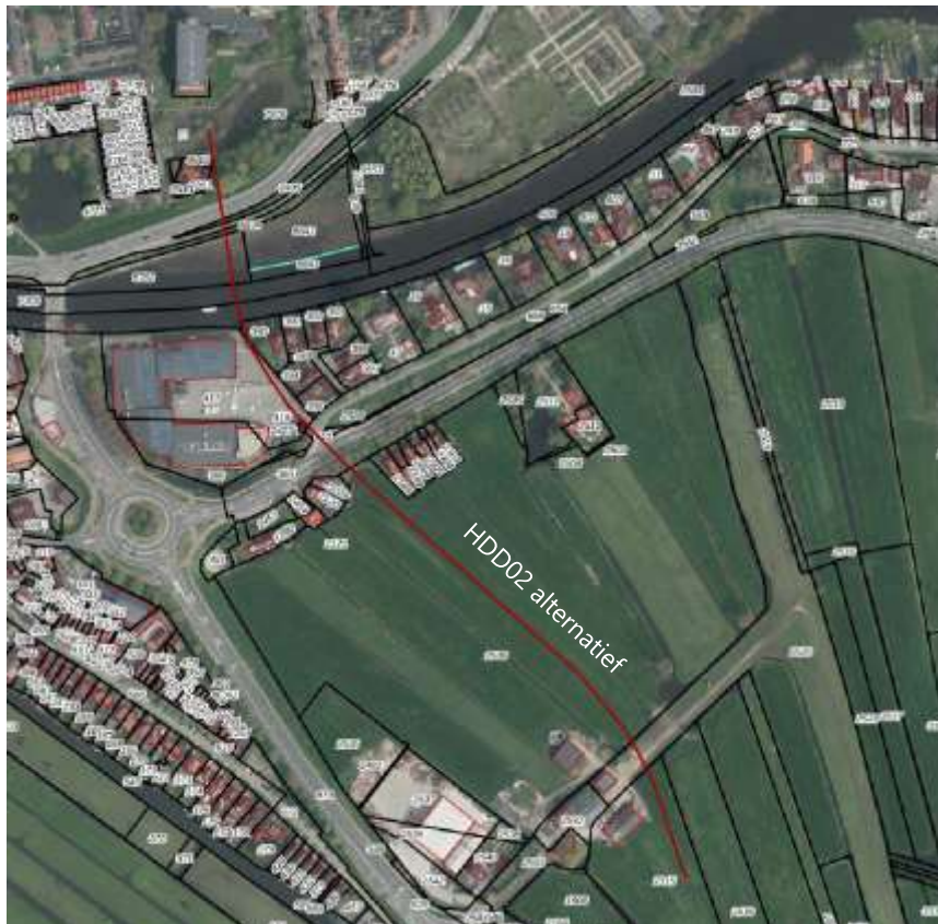
Afbeelding 4.10 Alternatief tracé voor HDD02 (rode lijn)
