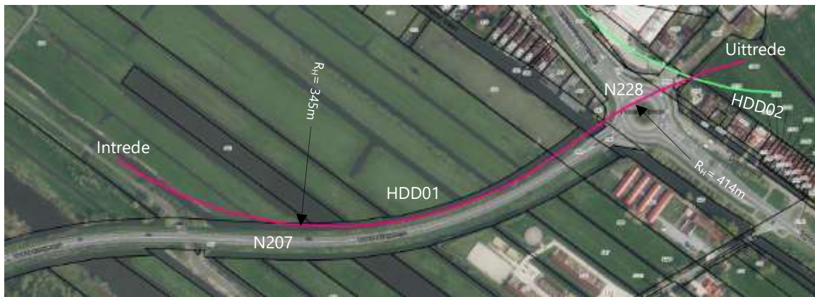
Afbeelding 4.4 Tracésectie HDD 01 (roze lijn)
