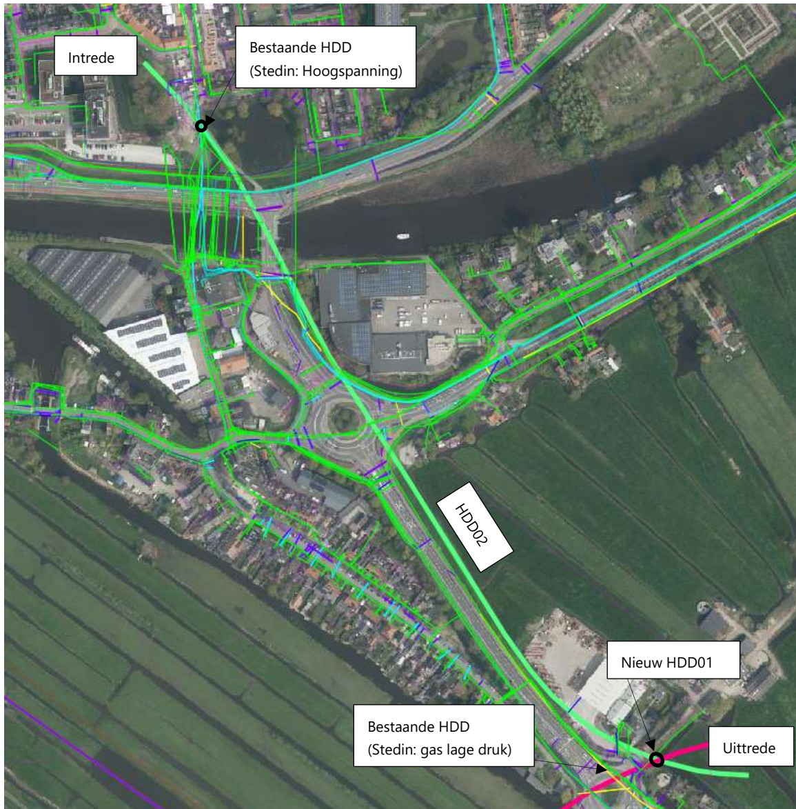
Afbeelding 4.11 Tracéssectie HDD02 (groene lijn) en KLIC
